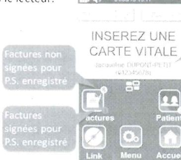
En mode déconnecté, KAP&GO passe automatiquement en mode veille au bout d'1 minute d'inactivité. Il sort de veille par insertion d'une carte, un appui court sur le bouton ou une connexion sur le poste de travail. Appuyer sur le bouton « Déverrouiller » si nécessaire.
